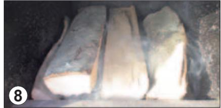
8 Nun die Vergaserkammer mit Brennholz beladen.
