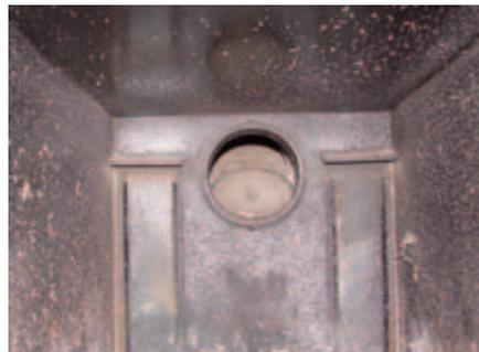
Vergasungskammer nach einigen Tagen Heizbetrieb. Die Teerbildung ist völlig normal und wird immer wieder mit abgebrannt.
