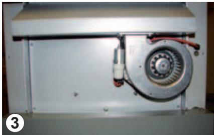
Schrauben des Ventilatorbleches lösen und das Blech samt Ventilator abnehmen.
