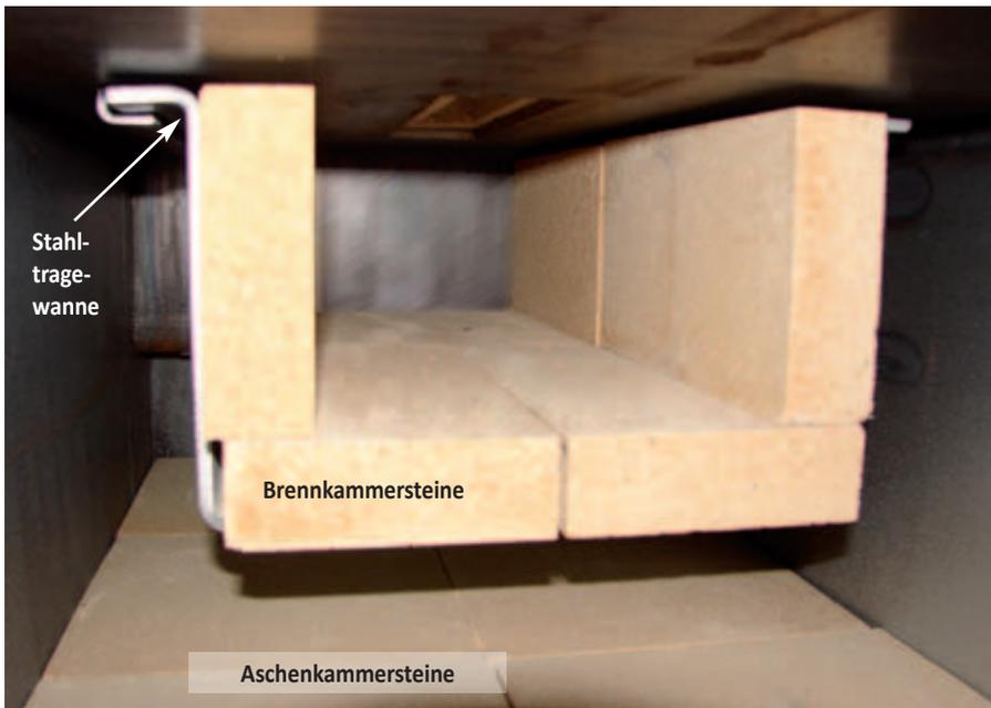
Die **Aschenkammersteine** sowie die **Brennkammersteine** sind Verschleißteile und müssen bei Bedarf ersetzt werden.
