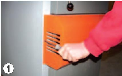
Die beiden Schrauben der Ventilatorabdeckung lösen und Ventilatorgehäuse abnehmen
