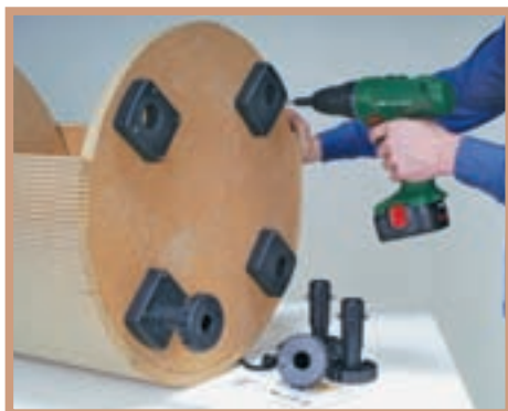
22. Cele 4 picioare reglabile vă ajută să ajustați exact înălțimea la care va fi situat corpul dulapului și să-l stabiliți definitiv poziția.
