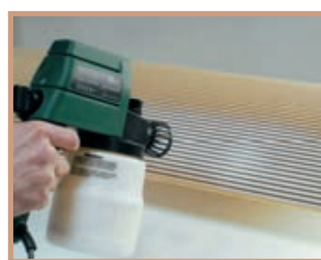
24. Dar înainte de montarea foliei veți vopsi corpul din MDF cu un lac (prin pulverizare), pentru a proteja materialul de acțiunea apei.
