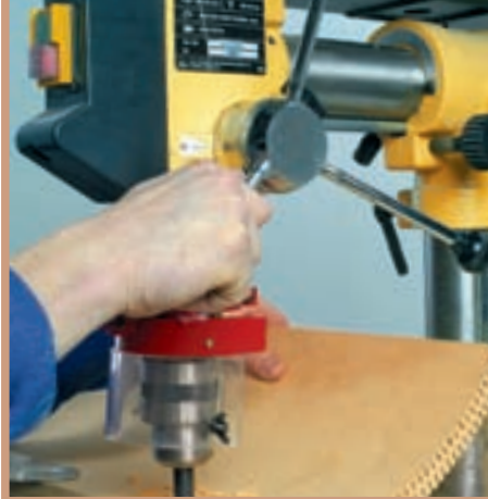
20. La montarea ușii veți utiliza balamale obișnuite, pentru fixarea cărora e necesară realizarea unor găuri pe suprafețele interioare curbate.
