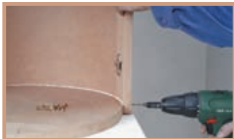
19. Deasupra și dedesubtul structurii vor fi înșurubate și înțeleite capace rotunde din MDF, astfel încât corpul să fie închis.
