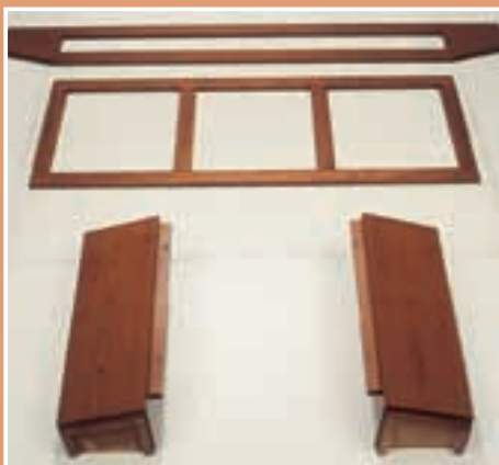
2. Componentele sunt executate la dimensiunile caloriferului. Fiind din esențe diferite (moale, respectiv tare) toate au fost băițuite în nuanță de nuc.
