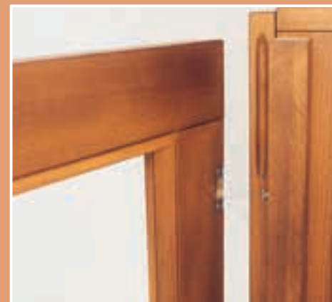
3. Elementele de feronerie montate pe panoul frontal sunt introduse în buloanele cu cap bombat ale dulăpioarelor, atât în stânga, cât și în dreapta.
