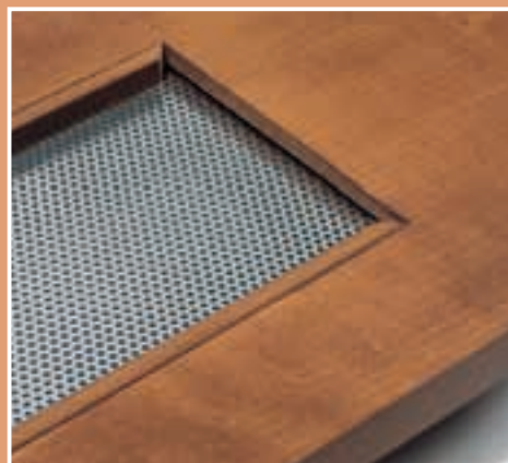
6. Tabla perforată a panoului orizontal a fost înșurubată pe dedesubt. Marginile decupajului au fost acoperite cu șipci tăiate la 45 de grade.
