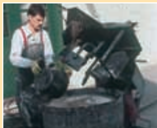
Adăugând o leșie din clorură de magneziu, componentele au fost amestecate într-un malaxor conectat la curent trifazic...
