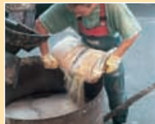
...până când a rezultat o masă vâscoasă. Pentru a putea obține consistența optimă, am adăugat nisip cuarțos special.
