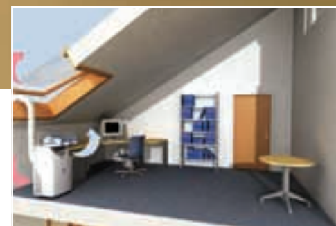
Aparatele de climatizare mobile evacuează căldura printr-o tubulatură. Există și variante în care acestea sunt racordate la un condensator zgomotos plasat separat, în exterior.
