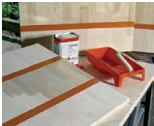
26. ... cu bandă adezivă. În scopul păstrării nuanței lemnului de arțar, pe acestea se va aplica un grund pentru lemn mătăsoș, în color și diluat în proporție de 10%.
