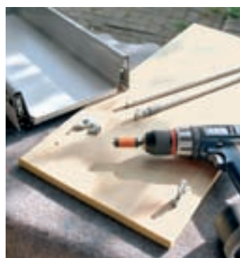
29. Șinele de ghidare a sertarelor glisante și alte accesorii necesare elementelor frontale și ușilor...
