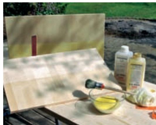
27. După uscarea lacului, zonele intermediare rămase neatinse trebuie vopsite cu un baft colorat, operațiune ce va demarca mai clar benzile cromatice.
