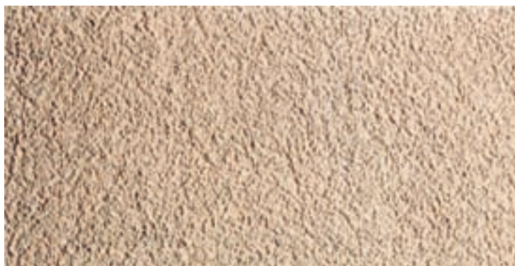
Aspect aglomerat, obținut cu produsul Ceresit CT 137, cu o granulație de 1,5 mm, realizat prin dișcuire cu o dișcă din plastic.
