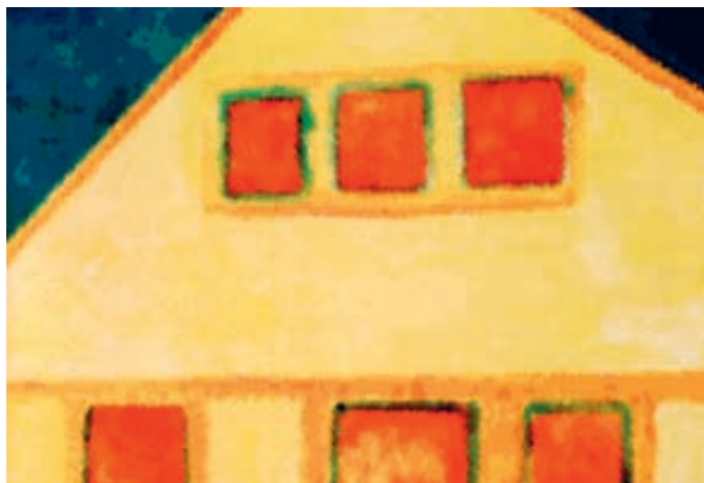
Fig.4. Se poate vedea în această imagine care este rezultatul izolării termice a pereților exteriori, imagine obținută cu ajutorul unui aparat termosensibil. În partea stângă, apar culorile galben și portocaliu, care indică pierderile de energie termică. Căldura care iese din interiorul clădirii nu ar trebui să ridice temperatura
